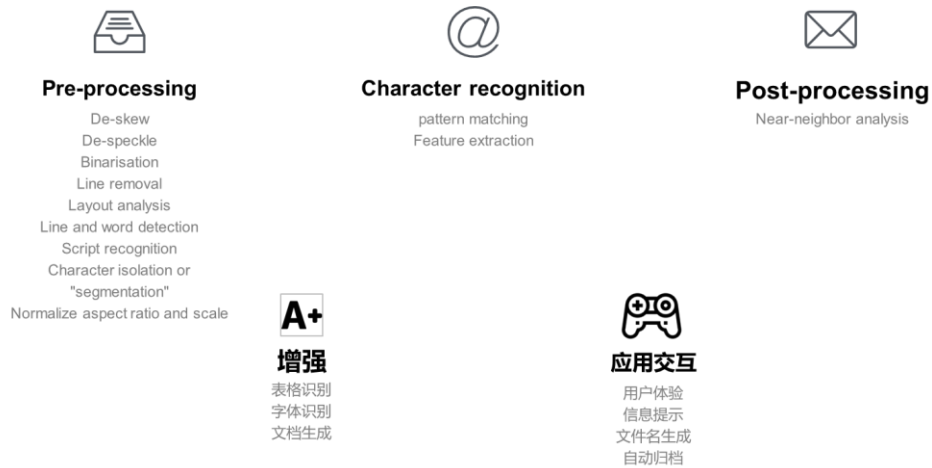
图 5-3-1 OCR 技术主要技术环节示意图
